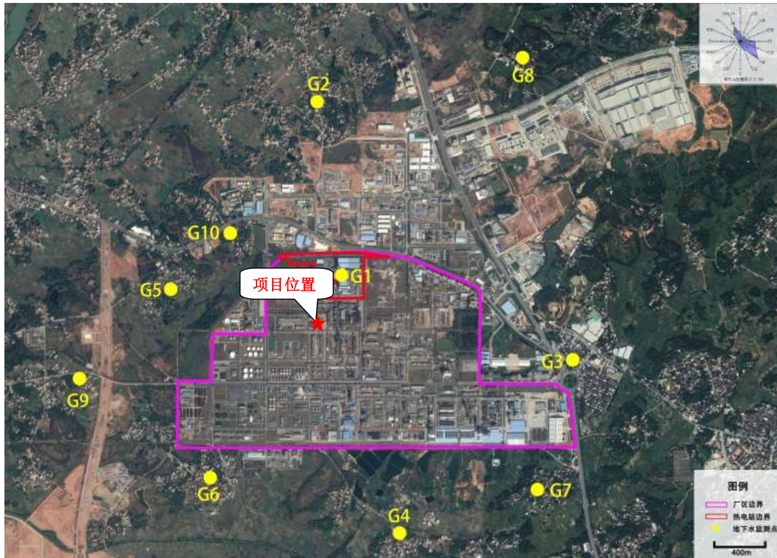
图 5.3-2 化工厂区地下水现状监测点位置图
